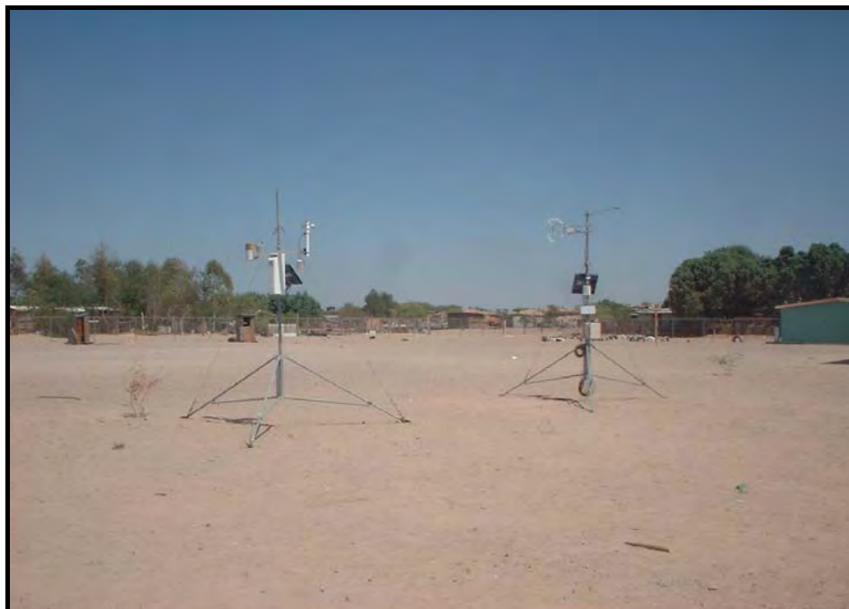
Fig. 4.2 Equipo de Correlación Turbulenta en Villa Emiliano Zapata
