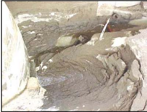
Cono de socavación, 85 min. en modelo.
