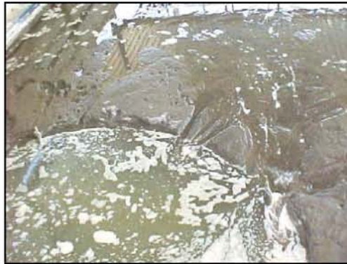
Cono de socavación, 55 min. en modelo.
