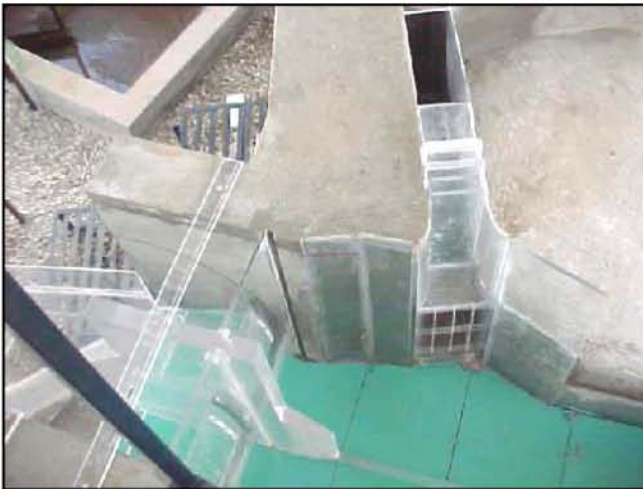
Estructura de control y la nueva obra de toma. desarenador.
