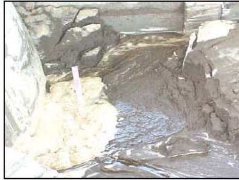
Cono de socavación, 95 min. en modelo.
