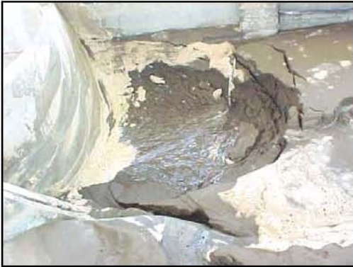
Cono de socavación, 120 min. en modelo
