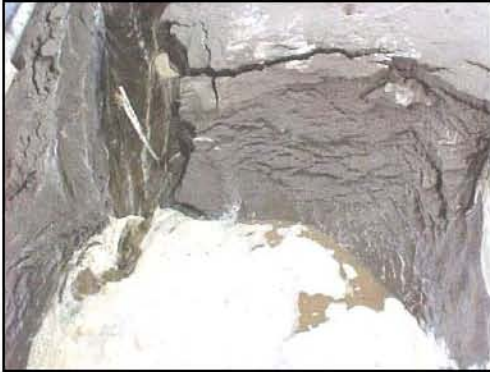
Cono de socavación, 55 min. en modelo.
