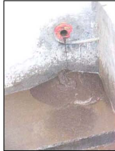
Inicio del ensaye, desagüe prácticamente obstruido
