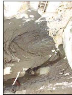
Cono de socavación, 90 min. en modelo.
