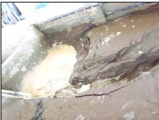
Cono de socavación, 93,3 min. en modelo
