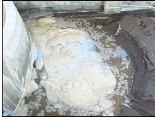
Cono de socavación, 80 min. en modelo.
