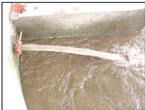
Desazolve de la Presa, 40 min. en modelo.
