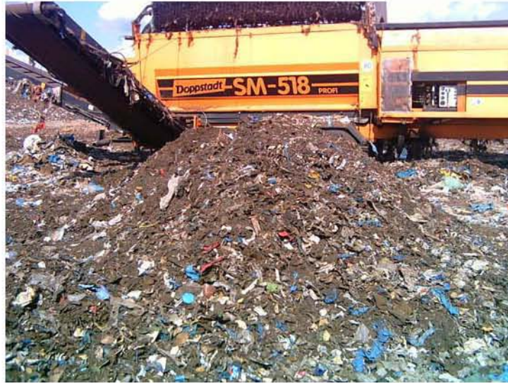
Figura 2.16 Trommel utilizado en relleno sanitario
