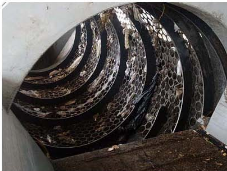
Figura 2.11 Trommel instalado en la planta de composta de Mérida
