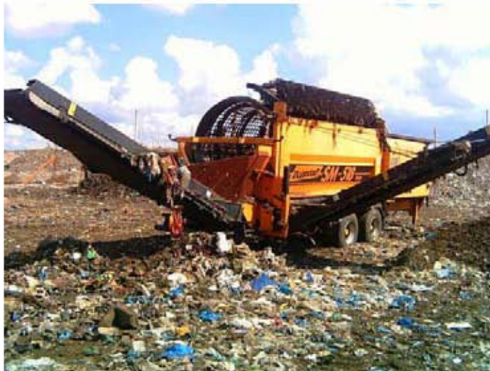
Figura 2.15 Trommel utilizado en relleno sanitario
