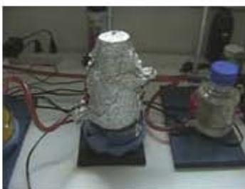
**Figura 2.1** Reactor utilizado para la agitación y lavado de las muestras.
