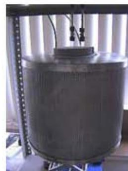
**Figura 2.3** Horno para el tratamiento térmico de las muestras.
