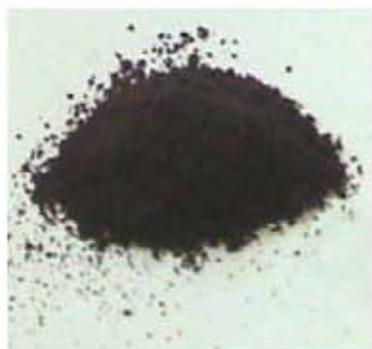
Figura 3.1 Au/Al<sub>2</sub>O<sub>3</sub> 16 h, 150°C, H<sub>2</sub>
