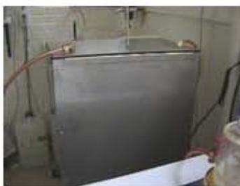
**Figura 2.2** Recirculador de agua, a 82 °C, la cual circula a través del reactor para mantenerlo a una temperatura de 80 °C.
