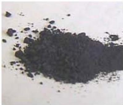
Figura 3.24 Au/TiO<sub>2</sub> 16 h, 150°C, H<sub>2</sub>.
