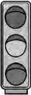
**LUZ ROJA:** los conductores deberán detener la marcha de sus vehículos en la línea de alto marcada sobre la superficie de rodamiento.
