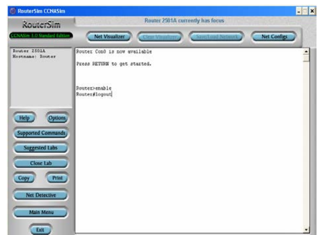
Figura 2.5 Línea de comando del router
