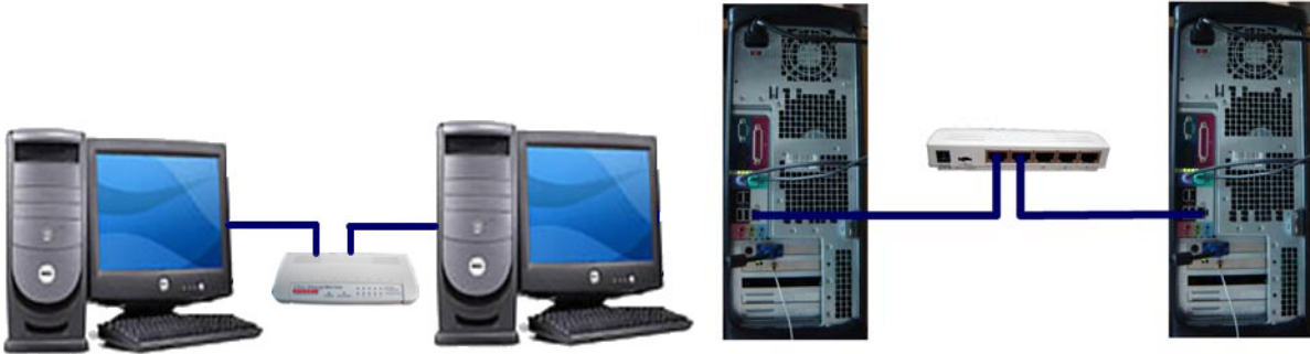
Figura 1.13 Conexión a través de un dispositivo de capa física
