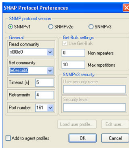
Figura 3.24 Cambiando los valores de configuración de SNMPv1
