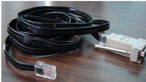
Figura 3.18 Cable de conexión al router
