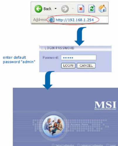
Figura 7.8 Acceso al Access Point.
