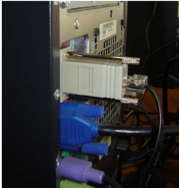
Figura 3.20 Conexión al puerto serie de la estación de trabajo
