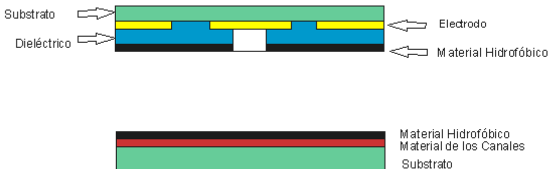
Fig. 6.3 Corte Transversal del Dispositivo mostrando las distintas capas de materiales
