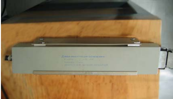
Figura 5.4: por un lado el amplificador tiene un conector coaxial que es la entrada al Amplificador y por el otro un conector especial que es la salida del Amplificador.
