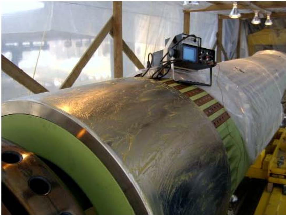
Figura 4.9 Apoyo en inserción del rotor del Generador Eléctrico
