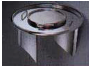
Figura 8: Barras intensificadores de mezclado para Mezclador Bohle
