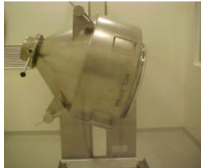
Figura 6: Mezclador Bohle con baffles internos
