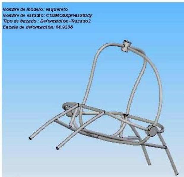
FIGURA 3.3.3 La carga fue perpendicular a la parte inferior del fuselaje, con un acero 1020. La escala de estas deformaciones están aumentadas en 64.9.
