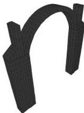
Figura 3-18. Modelo matemático de la porción de nave central utilizada para validar el efecto del peso propio a través de una función que representa la fuerza de gravedad.
