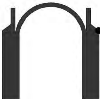
Figura 3-19. Punto en el que se evaluaron esfuerzos debidos al peso propio para verificar que la función de la fuerza de gravedad represente adecuadamente los esfuerzos.
