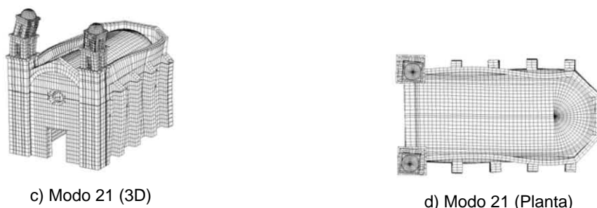
c) Modo 21 (3D) d) Modo 21 (Planta) Figura 4-12. Modo de vibrar número 21 que influencia el comportamiento sísmico del ábside en el Prototipo.
