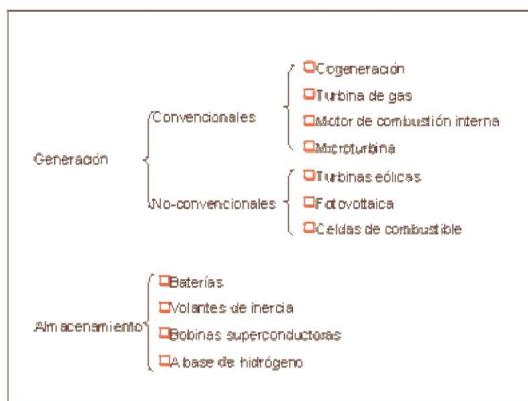
Figura 4.2. Tecnologías de Generación Distribuida
