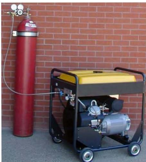
Figura 4.5 Generador Eléctrico de 7 kW alimentado con H 2 O gasolina.
