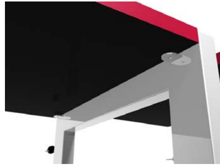
ensamble marco con repisa fija por medio de pijas.
