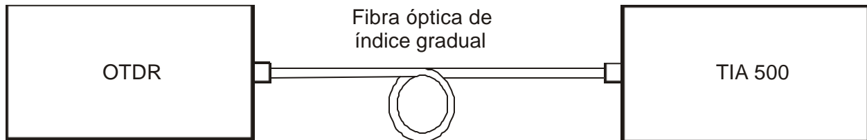
Figura 5.3 Diagrama de bloques para la medición de la dispersión con el equipo OTDR y el receptor óptico TIA 500.
