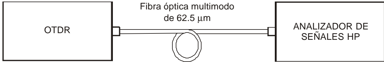
Figura 5.2. Diagrama de bloques para la medición de la dispersión con el equipo OTDR y el analizador de señales HP.
