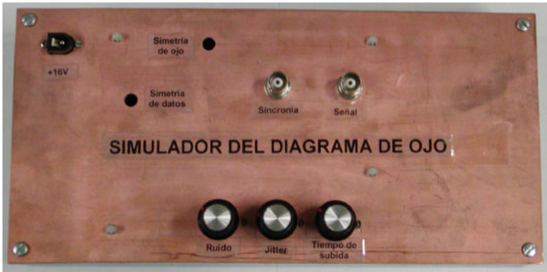
Figura 4.26 Simulador del diagrama de ojo en su caja.
