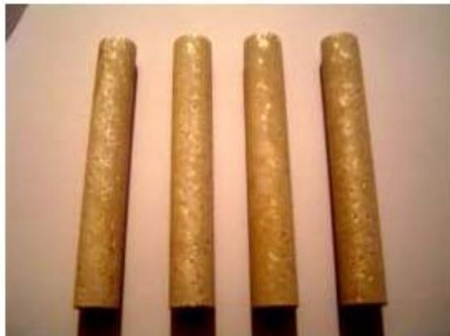
Figura 3.2.4a. Ánodos 1, 2, 3 y 4 en agua de dureza media a temperatura ambiente después de la prueba.
