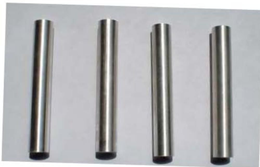
Figura 2. Ánodos de magnesio maquinados.
