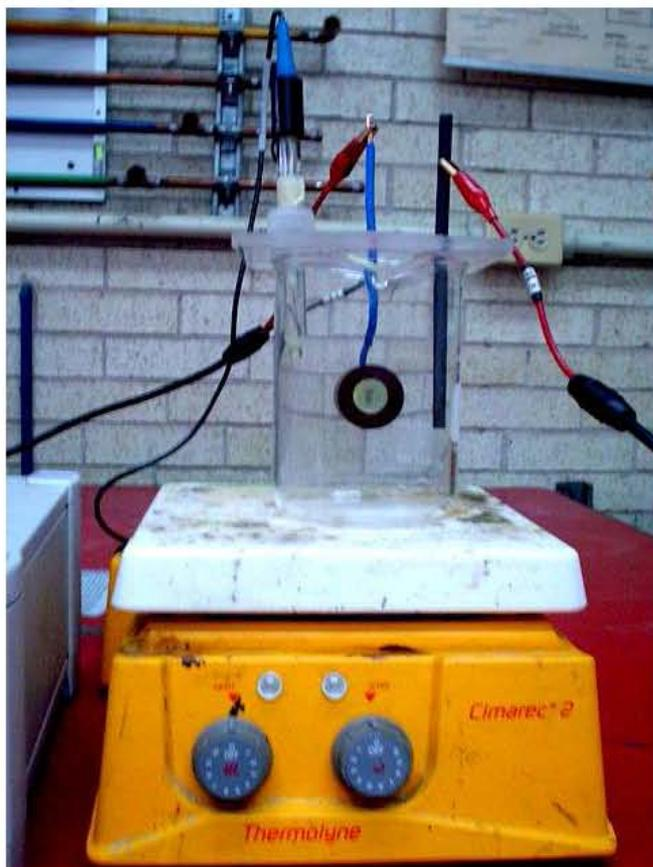
Figura 7. Celda utilizada para realizar las curvas de polarización.
