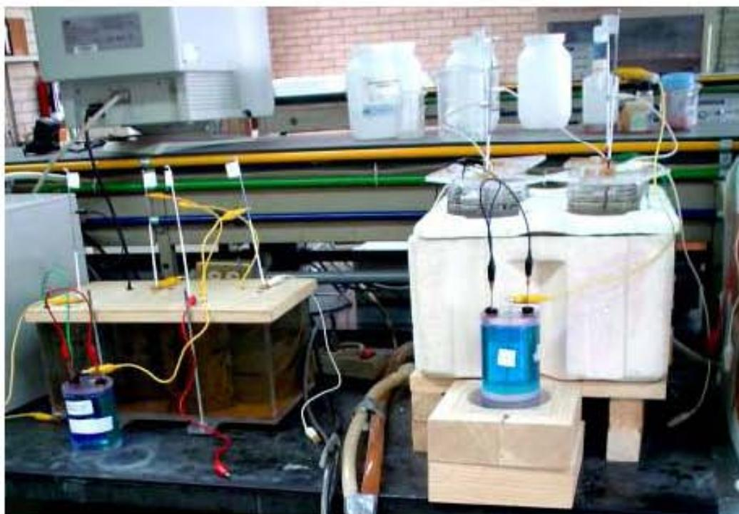
Figura 5. Celdas usadas para llevar a cabo las pruebas en los ánodos.
