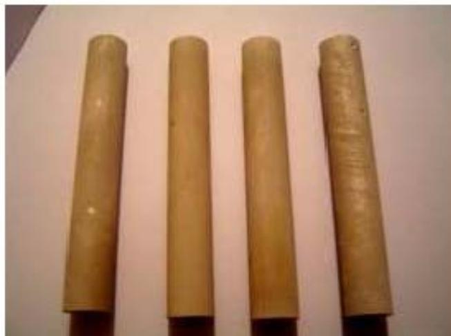
Figura 3.2.3a. Ánodos 1, 2, 3 y 4 en agua blanda a temperatura ambiente después de la prueba.
