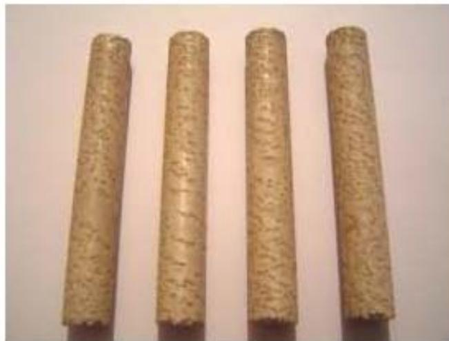
Figura 3.2.6a. Ánodos 1, 2, 3 y 4 en agua blanda a una temperatura de 60°C después de la prueba.
