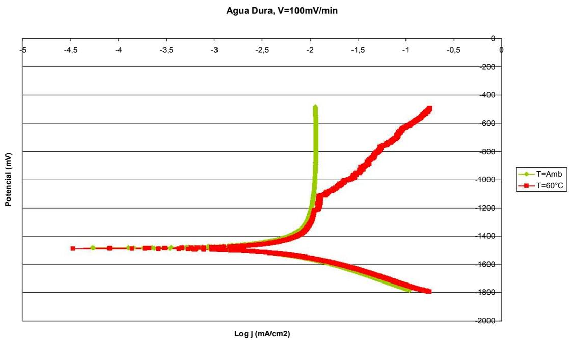
Figura 3.3.8. Curvas de polarización. Efecto de la temperatura para una agua dura a una velocidad de barrido de 100 mV/min.
