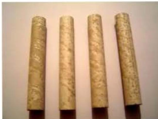
Figura 3.2.5a. Ánodos 1, 2, 3 y 4 en agua dura a temperatura ambiente después de la prueba.
