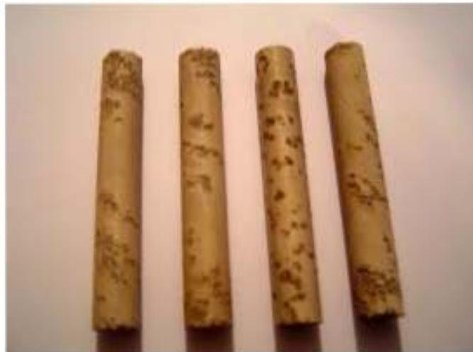
Figura 3.2.8a. Ánodos 1, 2, 3 y 4 en agua dura a una temperatura de 60°C después de la prueba.
