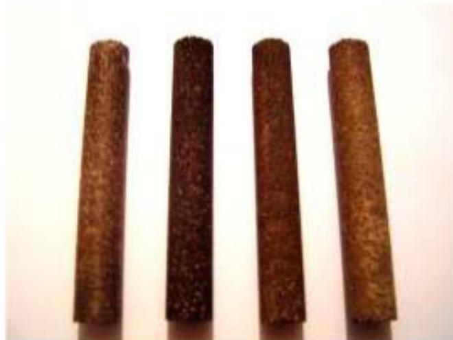
Figura 3.2.7a. Ánodos 1, 2, 3 y 4 en agua de dureza media a una temperatura de 60°C después de la prueba.
