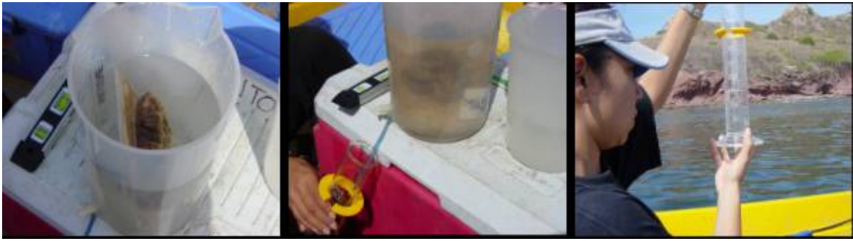
Fig. 6.1. Determinación de volumen de los ejemplares trasplantados por el método de desplazamiento volumétrico.
