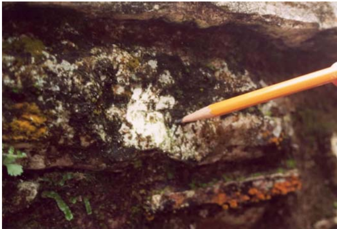
Figura 23. Desprendimiento del crecimiento con restos del sustrato.
