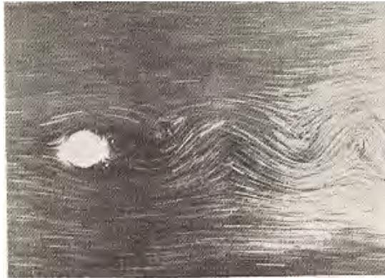
Fig. 3.64.- Estela de von Kármán  $wd/v = 250$ . La cámara esta en reposo con respecto a el cilindro.
