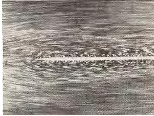
**Fig. 3.73.-** Flujo alrededor de una placa de longitud  $L$ .  $w L/v = 3.0$
