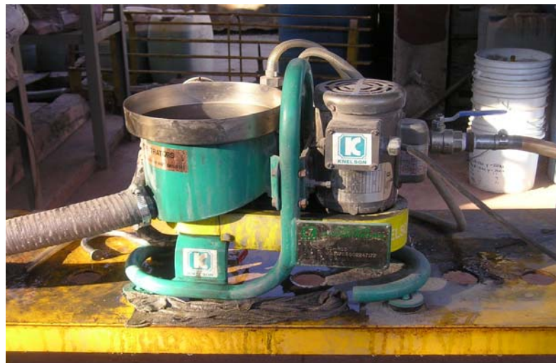
Fig. 41 Concentrador Knelson Modelo KC MD-3 del CIDT
