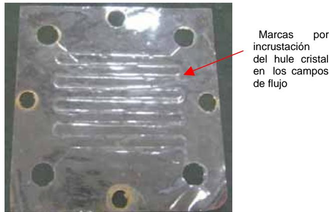
**Figura 4.3** Hule cristal para simulación de membrana de intercambio protónico.
