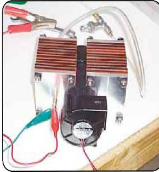
*Figura 1.8 Stacks de celdas de combustible prototipos en paralelo, el ventilador forza al aire a través de los stacks para su enfriamiento y proporcionando el oxígeno para la reacción.*
