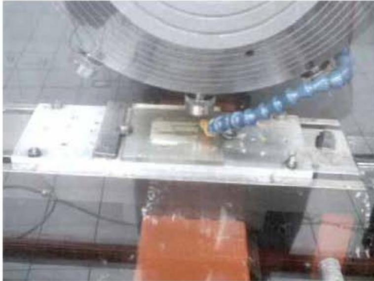
**Figura 4.10** Maquinado de las placas con campos de flujo con CNC.
