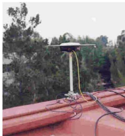
Fig III.3.5 Punto sobre base ubicado en el Instituto de Geofísica, identificado como UIGF.
