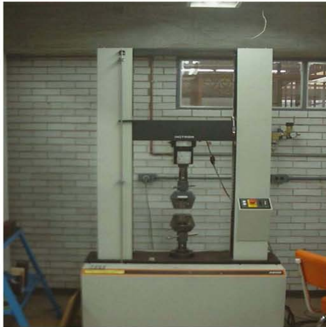
Figura 4.1. Máquina universal de pruebas electromecánica con el herramental para el ensayo de tracción.
