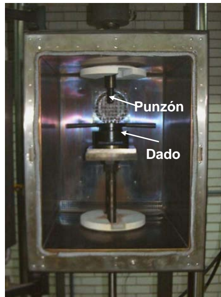
Figura 4.3. Máquina universal de pruebas servohidráulica con el herramental para el ensayo Erichsen.
