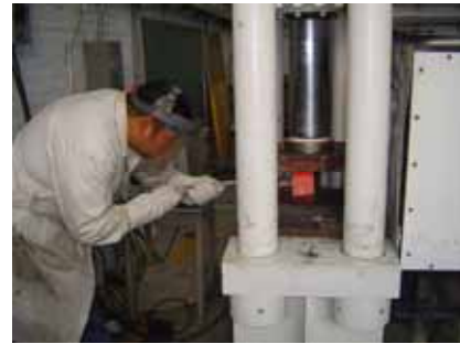
Figura 3.17 Colocación de la pastilla para el maclado
