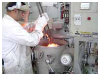
Figura 3.9 Retiro del crisol de la matriz del horno
