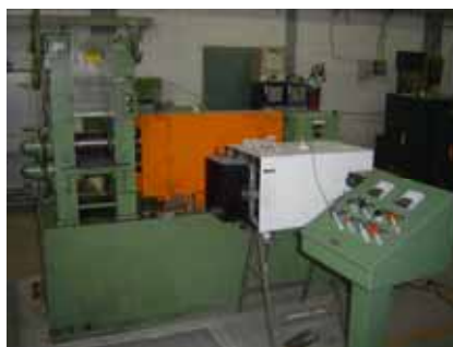
Figura 3.14 Equipo de laminación y horno de resistencias eléctricas tipo mufla (IIM – UNAM)
