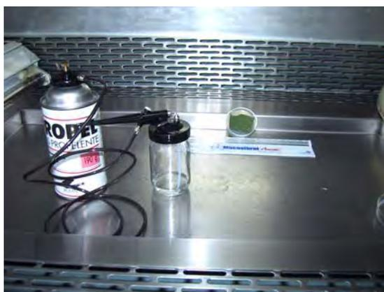
Fig. 16. Aspecto del aerógrafo utilizado para simular una aspersión en campo agrícola.
