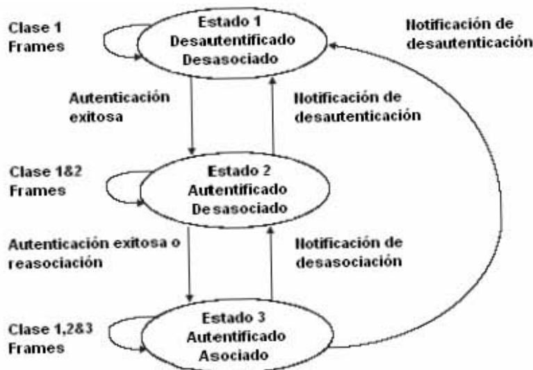
Figura 3-4 Estados de una estación de acuerdo a su relación con el AP
