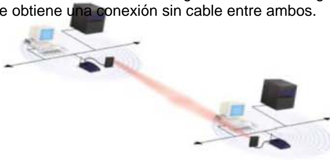
Figura 1-4 WLAN con antenas direccionales
