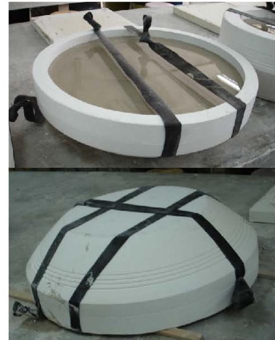
**DESMOLDE:** Con el molde escurrido y espesor calculado, se debe revisar la dureza de la pasta, para hacer el desmolde, retirar las ligas y voltear los moldes, el material esta perdiendo humedad y comienza un encogimiento, la gravedad ayuda a que por su propio peso salga la pieza. En este punto pueden romperse o deformarse las piezas.
