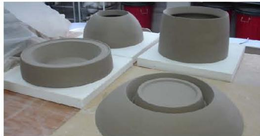
**QUEMADO SANCOCHO:** En esta etapa las piezas son muy frágiles y tiene que manejarse con cuidado, dentro del horno pueden apilarse, aprovechando todo el espacio, quemado a una temperatura de 850°. Después de enfriado el horno se pueden manipular con más seguridad, para el siguiente proceso de esmalteado.
