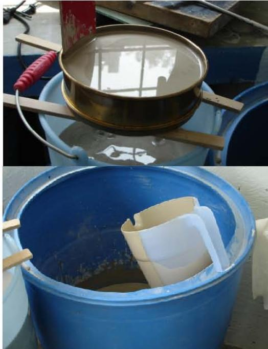
Preparación del molde, usando ligas que mantengan unidas las piezas que lo integran, vaciar la pasta y llenarlos por arriba del limite de la piezas, empezar a tomar el tiempo y calcular el espesor de la pared, para estas piezas la pared tiene que ser aproximadamente de 5 a 7 mm. Una vez teniendo el grosor se vacía el líquido sobrante dentro del molde, escurrir los moldes para evitar residuos y goteos.
