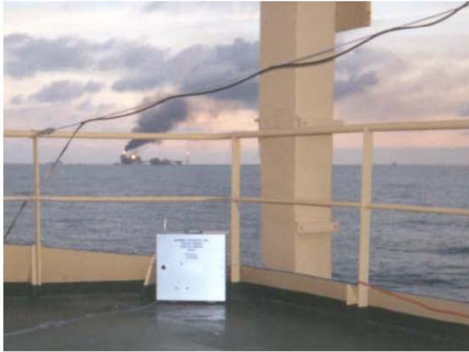
Figura 5.5.4. Muestreo de COVs cerca de plataformas con el muestreador Weeding & Associates
