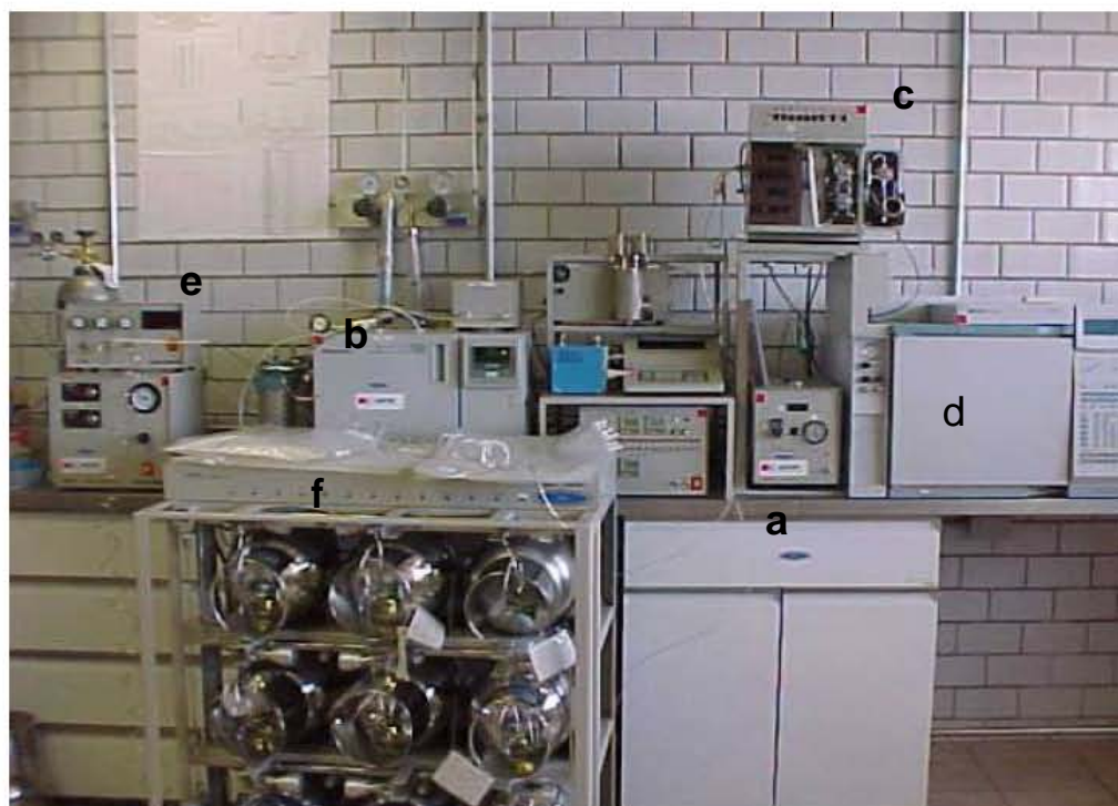
Figura 5.3.1. Sistema automático para muestreo y análisis de COVs en aire ambiente. (a- bomba de succión, b- controlador de humedad, c- sistema de preconcentración de muestra, d- Cromatógrafo de gases para análisis, e- Sistema de dilución y calibración, f- Rack para 9 canisters).
