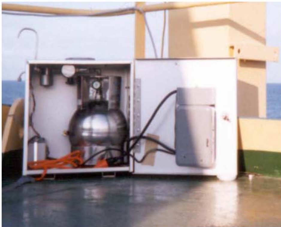
Figura 5.4.1. Detalle del equipo de muestreo de COVs mediante canisters
