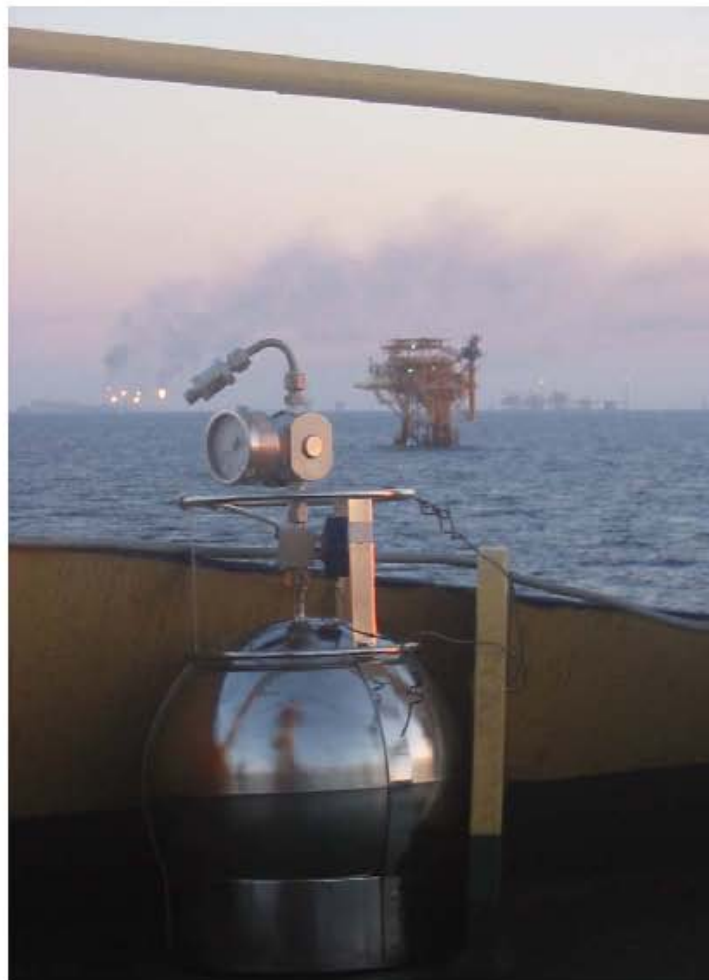
Figura 5.5.5. Muestreo de COVs cerca de plataformas con controlador de flujo de orificio crítico
