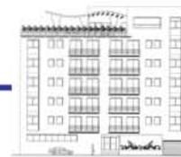
A diferencia del proyecto para tesis que la estructura se propone con columnas; este edificio se resolvió a base de muros de concreto de 20 centímetros de espesor que salvan claros de 10 x 10 metros sin columnas; siendo imposible proponer este mismo sistema estructural para el proyecto de tesis, debido al peso que este tipo de estructura provocaría en el terreno, siendo este de tipo Z-II.
