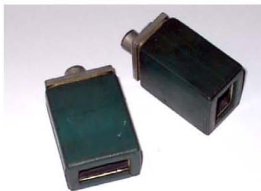
Figura 4.1 Transductores acústicos piezoeléctricos
