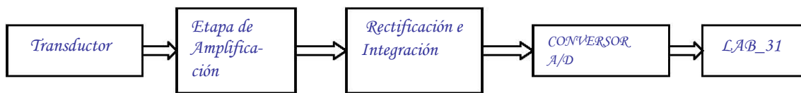
Figura 3.3 Amplificación y Adecuación de la señal del transductor.
