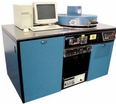
Figura 5.6 Cámara de deposición CVD
