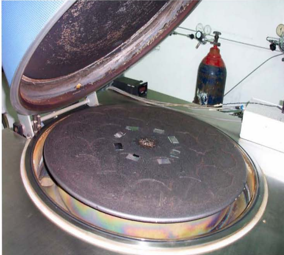
Figura 5. 18. Deposición del aluminio en un evaporador térmico.
