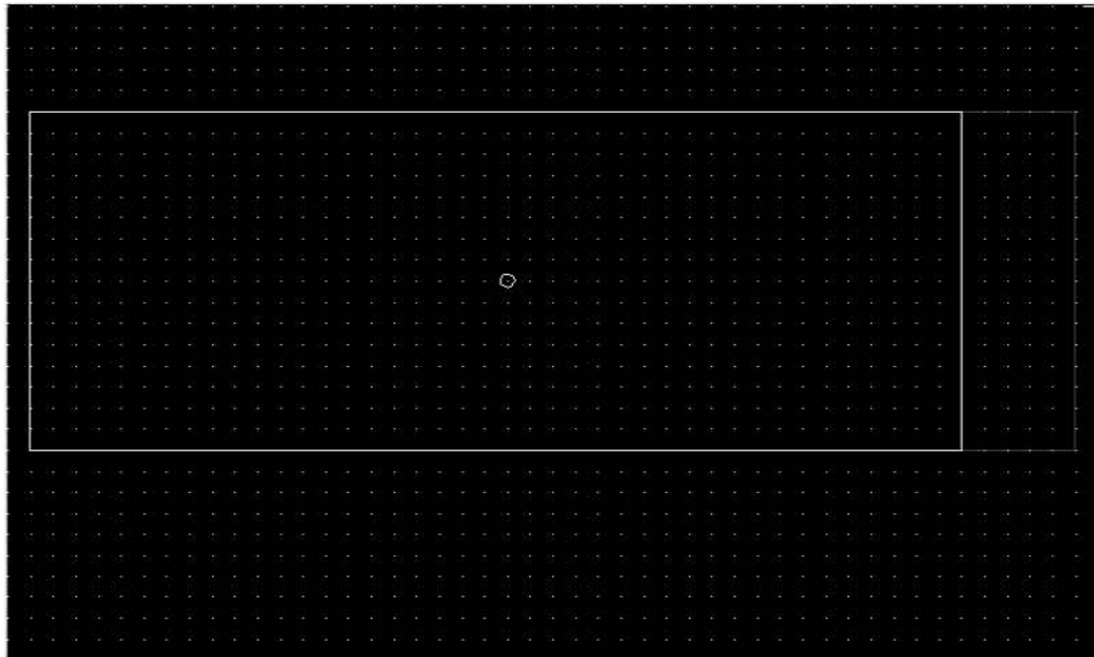
Figura 5.4. Mascara m0 para definir la capa de sacrificio que sirve de sostén a los microcantilevers.
