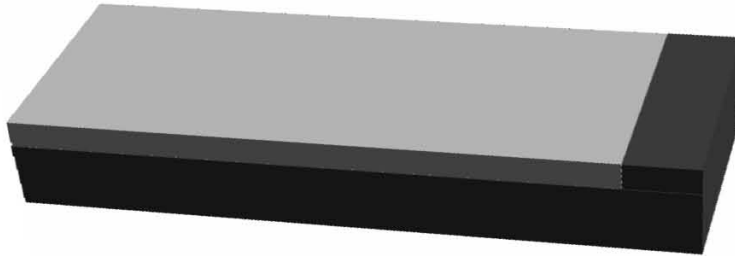
Figura 5.8 Anclaje de nitruro de silicio para los microcantilevers definido por la mascara m1.
