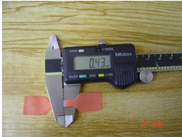
Fig. 19. Medición del espesor de la muestra mediante el uso de micrómetro digital Mitutoyo.
