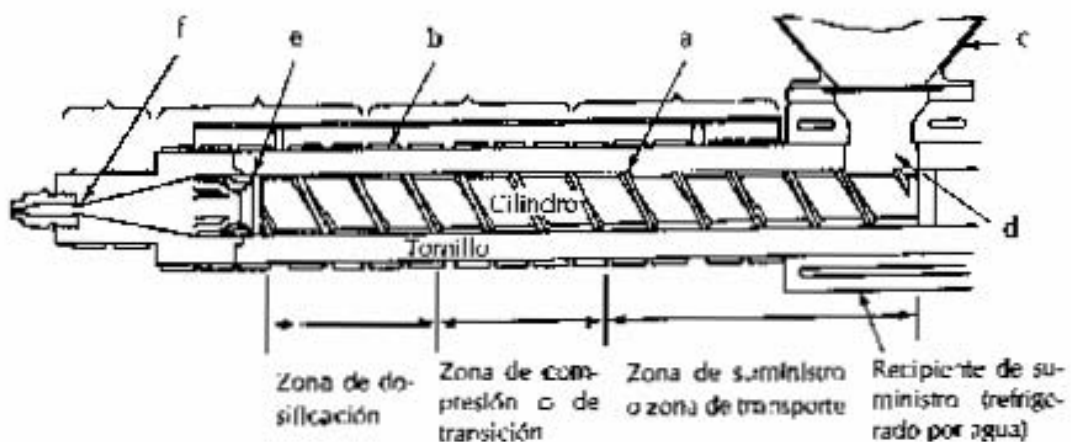
Fig. 2.2 Equipo de extrusión [R. Seymour. Introduction to Polymer Chemistry . 1971].
