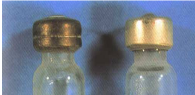
Figura 23. Corrosión de la tapa que rodea al diafragma. Gay
