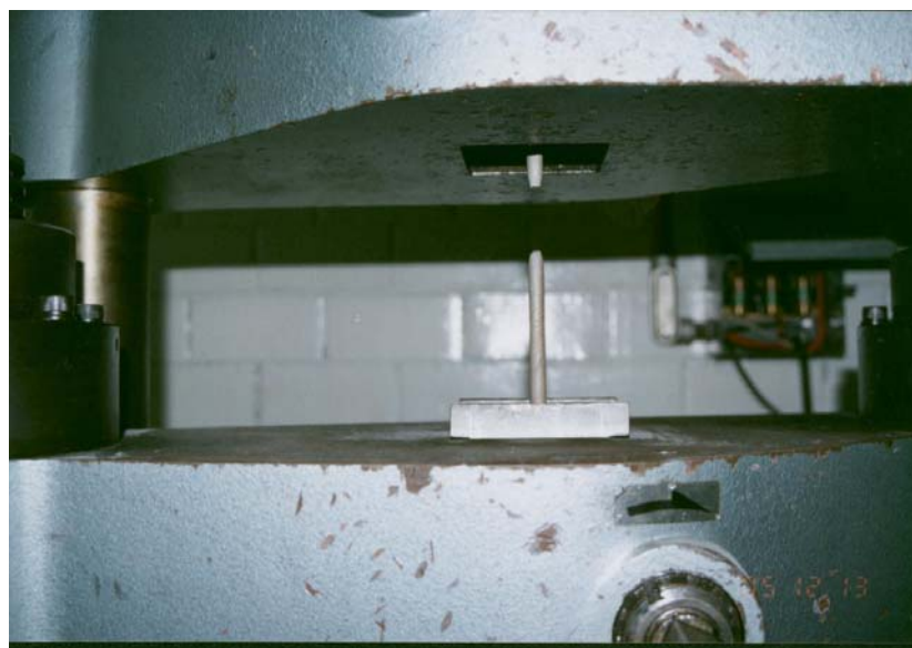
Fig. 63: Estado límite de Fluencia de las barras Imágenes tomadas por Jorge Vélez Carbajal
