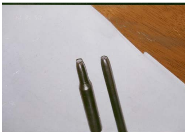
Fig. 65: Tipo de Fisura de Cráter Cónico Imágenes tomadas por Jorge Vélez Carbajal
