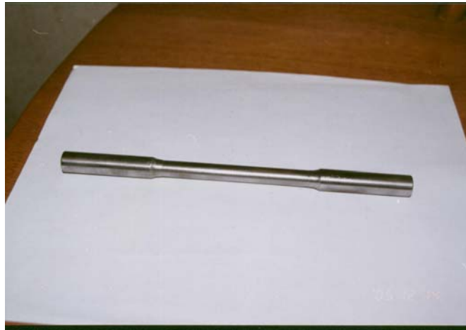
Fig. 58: Probeta terminada con los tres baños de metales Imágenes tomadas por Jorge Vélez Carbajal
