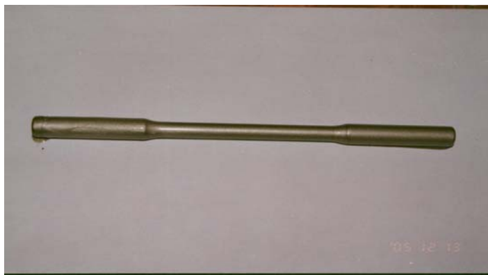
Fig. 53: Probeta recubierta con metal de Cobre Imágenes tomadas por Jorge Vélez Carbajal
