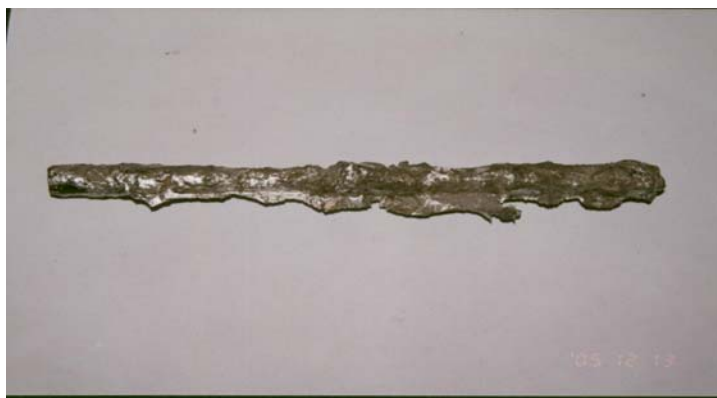
Fig. 54: Adherencia tipo del Aluminio en las barras Imágenes tomadas por Jorge Vélez Carbajal
