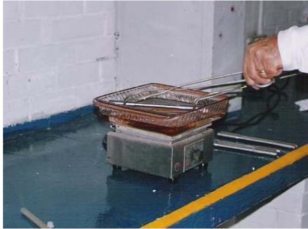
Fig. 44: Sumersión de probetas en la solución Imágenes tomadas por Jorge Vélez Carbajal
