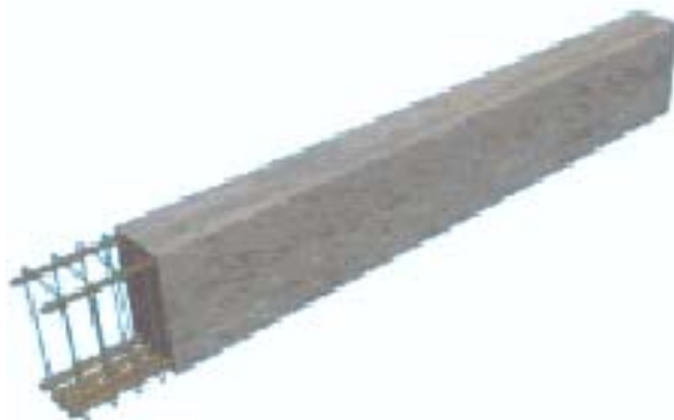
Figura 26: Detalle de refuerzo confinado con Acero electrostático en secciones horizontales (Visión prospectiva de estructuras)
