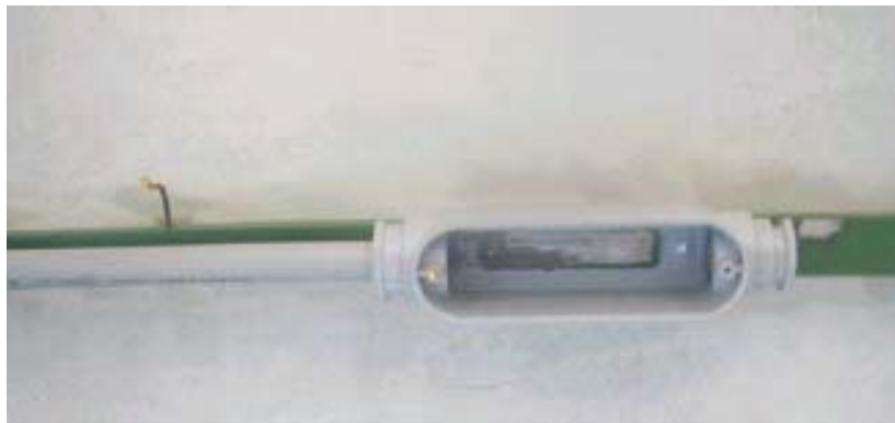
Figura 21. Deformímetros tipo en el acero electrostático. (Imagen tomada de la Universidad de Toronto Canadá, por A. A. Mufti
