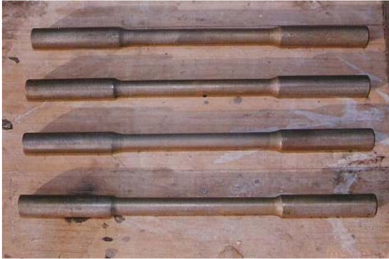
Fig. 49: Apariencia final de las probetas después del baño Imágenes tomadas por Jorge Vélez Carbajal
