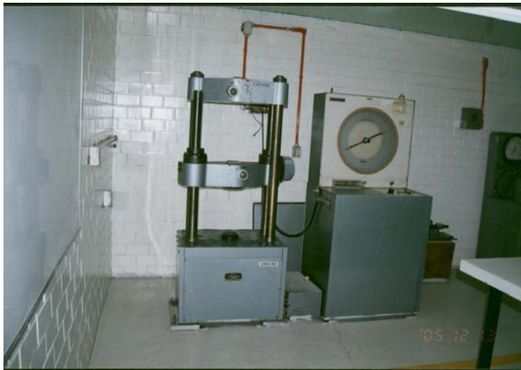
Fig. 60: Máquina de Esfuerzo – Deformación para metales Imágenes tomadas por Jorge Vélez Carbajal
