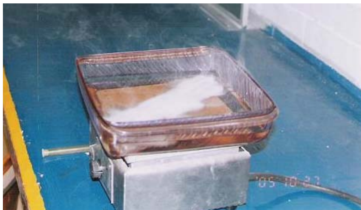
Fig. 48: Probetas sumergidas en solución con ácido clorhídrico Imágenes tomadas por Jorge Vélez Carbajal
