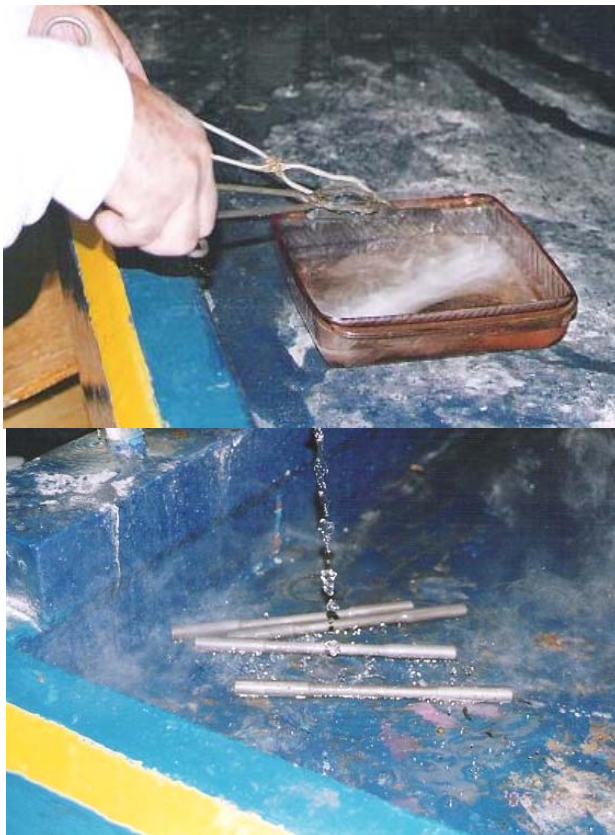
Figura 46: Baño de probetas con agua helada Imágenes tomadas por Jorge Vélez Carbajal
