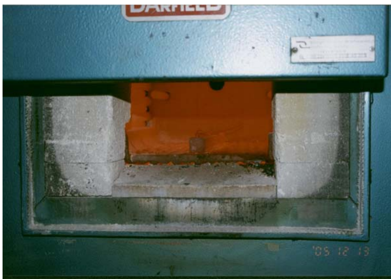
Fig.52: Horno en incandescencia fundiendo cobre Imágenes tomadas por Jorge Vélez Carbajal
