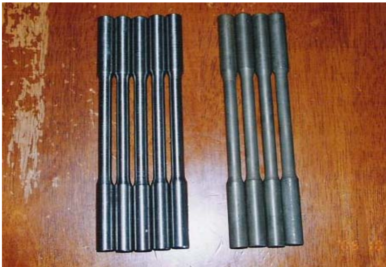
Figura 50: Diferencias por rugosidad en probetas Imágenes tomadas por Jorge Vélez Carbajal
