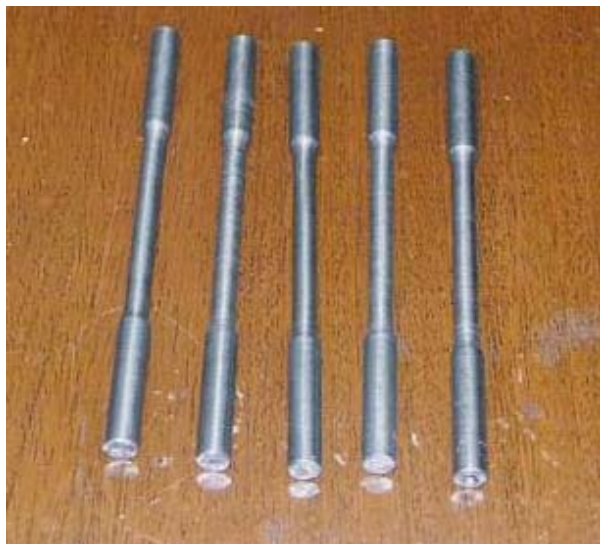
Figura 40: Torneado Final en probetas Imágenes tomadas por Jorge Vélez Carbajal
