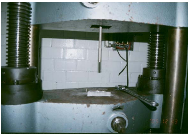
Fig. 61: Tipo de Colocación para la prueba a tensión Imágenes tomadas por Jorge Vélez Carbajal
