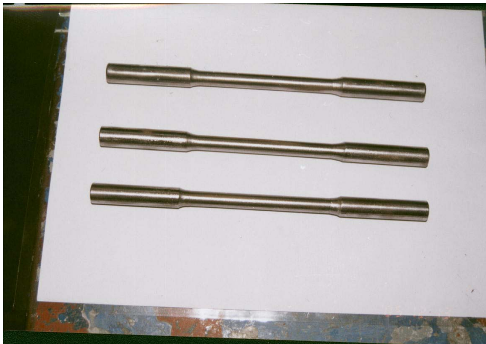
Fig.59: Acabado Final de las Probetas con Níquel y Cromo Imágenes tomadas por Jorge Vélez Carbajal
