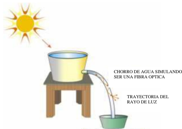
FIGURA 2-1. Experimento de Tyndall.
