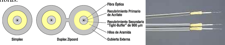
Figura 2-32.- Cables monofibra y bifibra.
