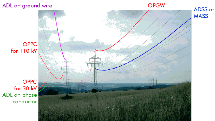
Figura 4-1.- Diferentes opciones de cables ópticos.
