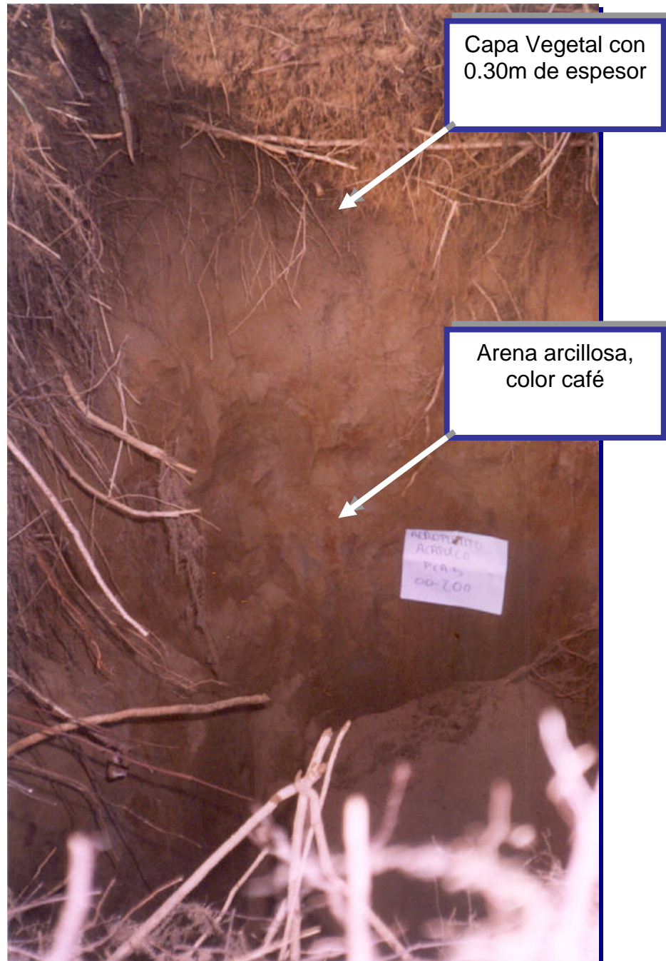
FOTO 10. Al igual que la excavación anterior, en el PCA-5 se presentan los mismos materiales, siendo en esta ocasión el espesor de la capa vegetal de 30 centímetros.
