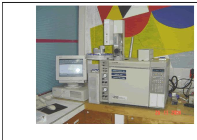
Cuando la solución de la muestra se presenta en la columna, los compuestos orgánicos se evaporan y se mueven a través de la columna por el gas transportador. Viajan a través de la columna diferentes tasas, dependiendo de las diferencias entre los coeficientes de participación, entre las fases móviles y estacionarias.
