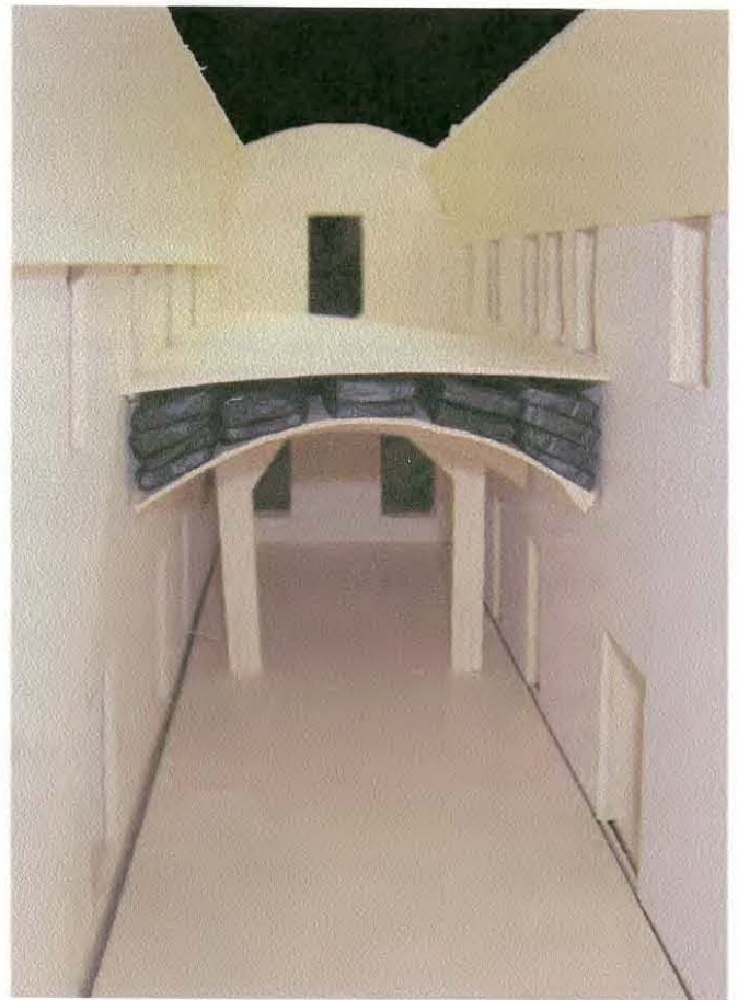
Cilíndrica larga de entepiso recibiendo relleno.
