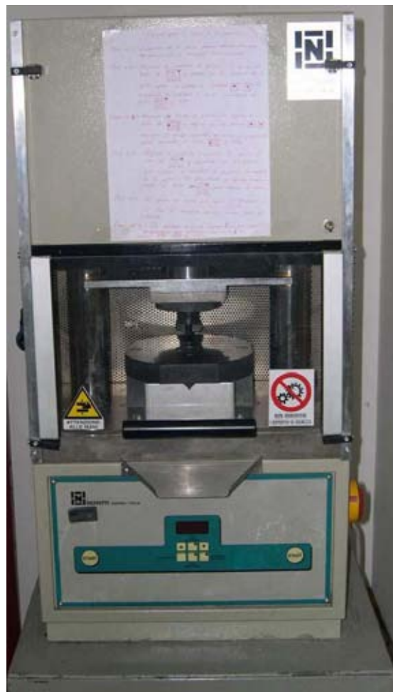
Figura 9. Prensa empleada para la fabricación de las pastillas.
