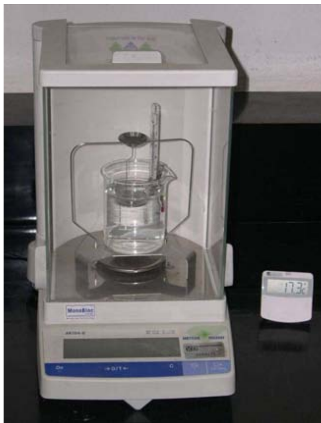
Figura 10. Balanza empleada para la determinación de la densidad de las pastillas.
