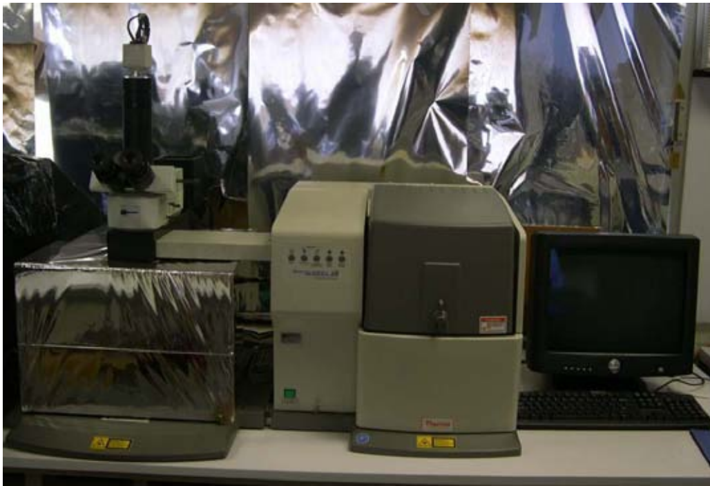
Figura 12. Espectrofotómetro Raman de altas frecuencias en el que se analizaron las soluciones sólidas.
