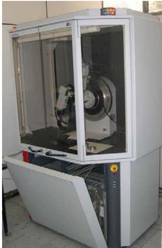
Figura 8. Difractómetro de rayos X empleado en el análisis de las muestras.
