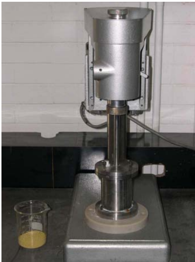
Figura 6. Molino de atrición y medios de molienda empleados durante el proceso de molido.
