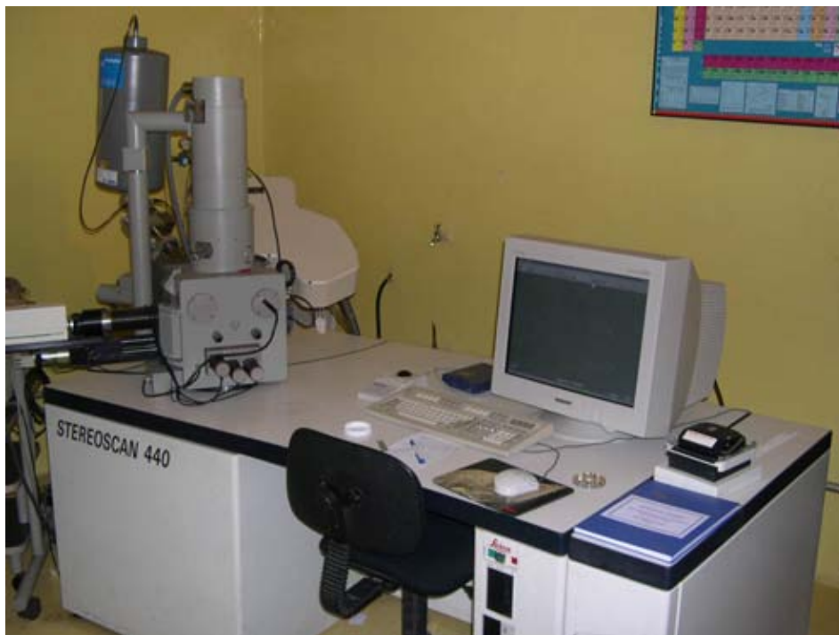
Figura 13. Microscopio electrónico de barrido con el que se observó la morfología de las pastillas.
