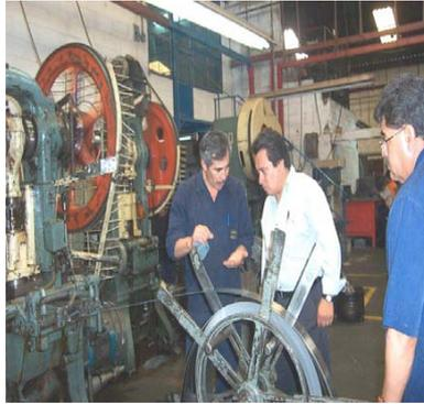
En la rueda giratoria en donde se coloca el fleje para alimentar a la troqueladora, se corre el riesgo de accidente debido a que la rueda gira al ser jalada por el fleje dentro del troquel. Por lo que al no ver ningún protector para esto, cualquier trabajador puede ser golpeado por las soleras de la rueda giratoria o puede jalar la ropa del trabajador hacia la misma rueda ocasionando accidentes y lesiones.
