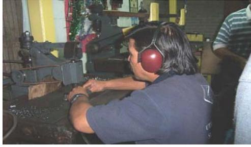
Para remachar los eslabones es necesario que el operario coloque el eslabón con las manos y después con el pie apretar un pedal que hace funcionar a la remachadora golpeando los casquillos para que el eslabón quede remachado.
