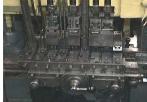
En la armadora semiautomática al momento de remachar la cadena se tiene que realizar un golpe el cual puede provocar un accidente al operario debido a que la mesa de trabajo esta a la altura de la cintura y les es fácil recargarse en ella, por tal motivo existe un gran riesgo de trabajo.
