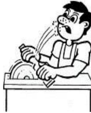
El principio que se sigue para la protección de maquinaria, es que de ninguna manera pueda tenerse contacto con las partes que significan riesgo: engranajes, elementos cortantes, proyección de materiales, etc.
