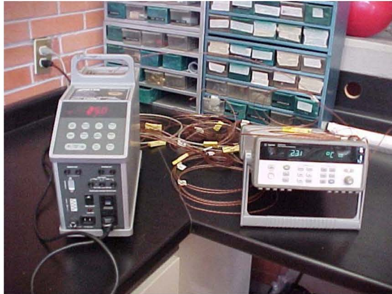
Figura 4.10: Fotografía del proceso de calibración de los termopares.
