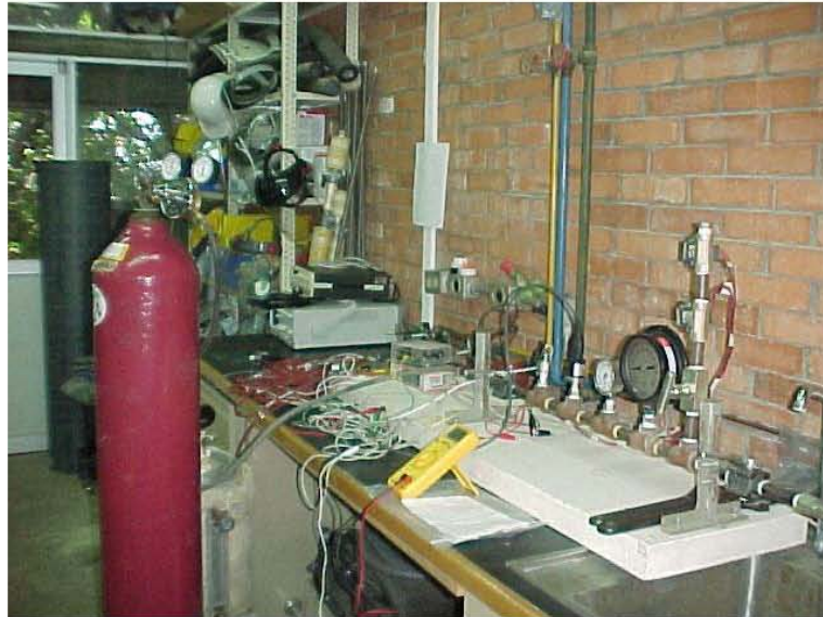
Figura 4.12: Fotografía del equipo utilizado en la calibración de los transductores de presión.
