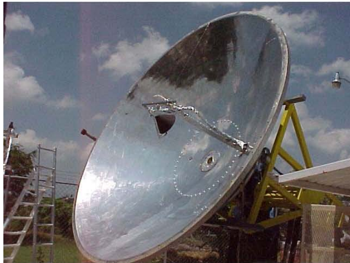
Figura 4.16: Fotografía de la vista de la instrumentación del receptor montado en el concentrador.
