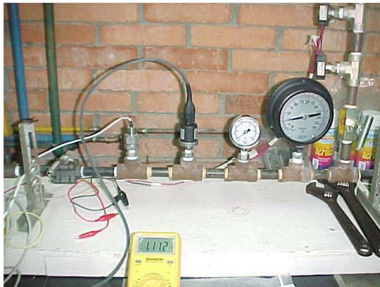
Figura 4.13: Fotografía del sistema de calibración de los transductores de presión.
