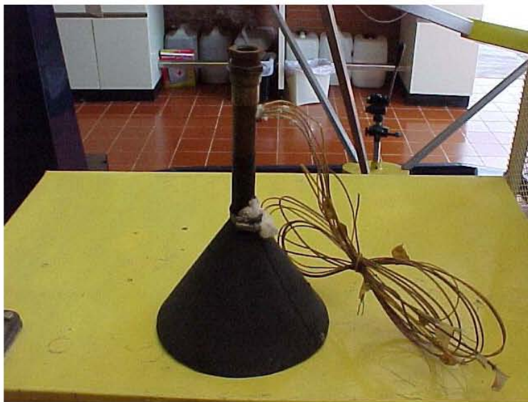
Figura 4.8: Fotografía del receptor cónico sin remoción de calor.
