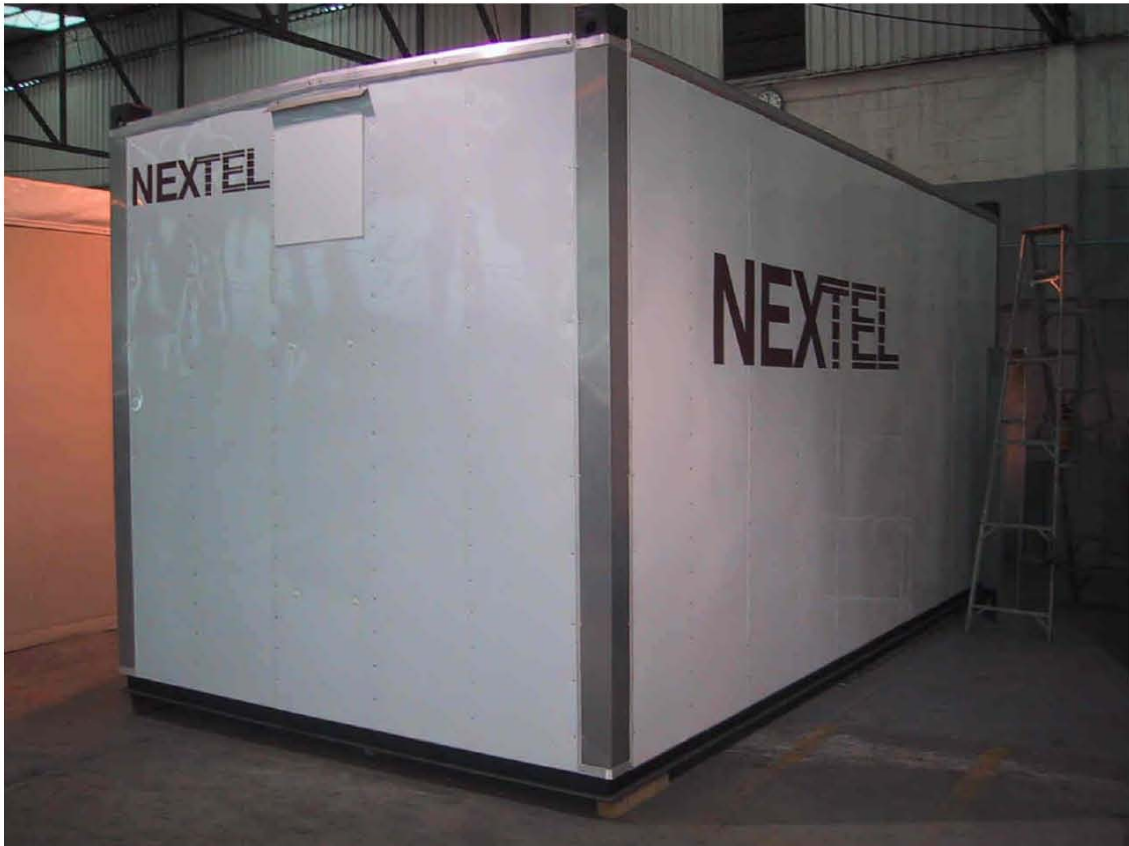
Shelter o Contenedor tipo “Pre-Ensamblado” (Estructural)
