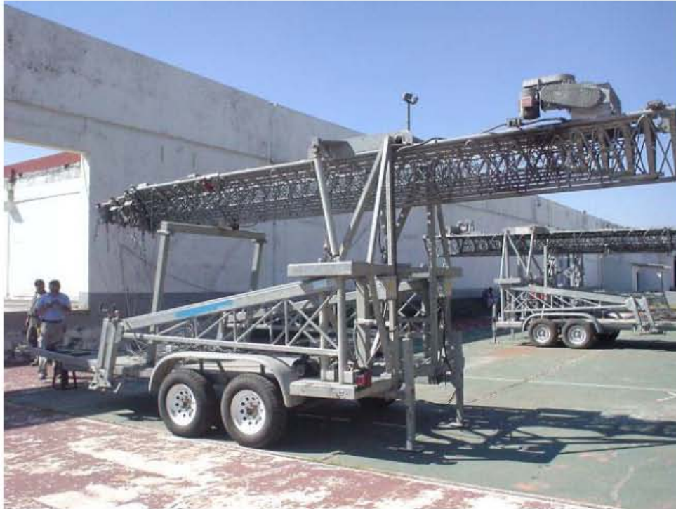
Estructura de COW con antena telescópica abatible para telefonía celular
