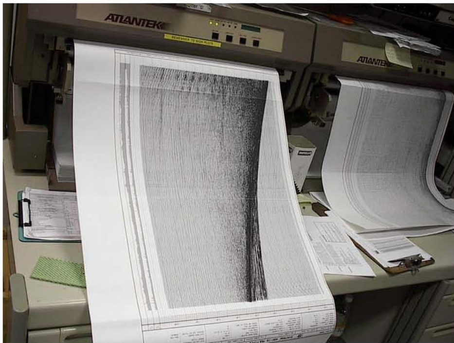
Figura III.4 Fotografía que muestra la verificación visual de disparos individuales en tiempo real, es decir disparo por disparo del Levantamiento Almeja -Cisne 3D (Pemex Exploración y Producción et al, 2003).
