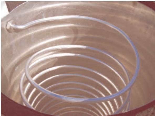
Fig. 6.11 Serpentín del condensador
