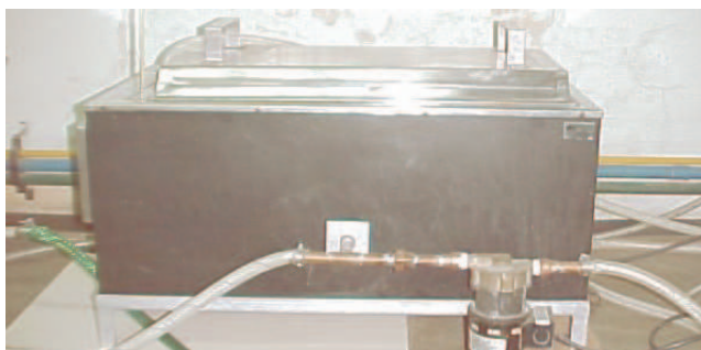
Fig. 4.8 Baño térmico con su termostato diferencial y la bomba
