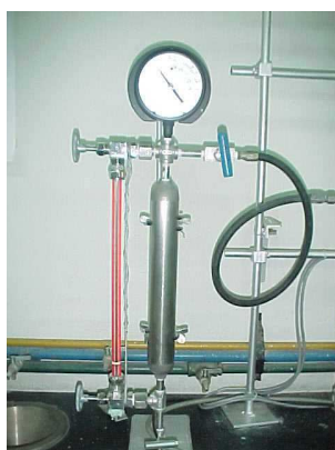
Fig. 4.7 Sistema de suministro de refrigerante
