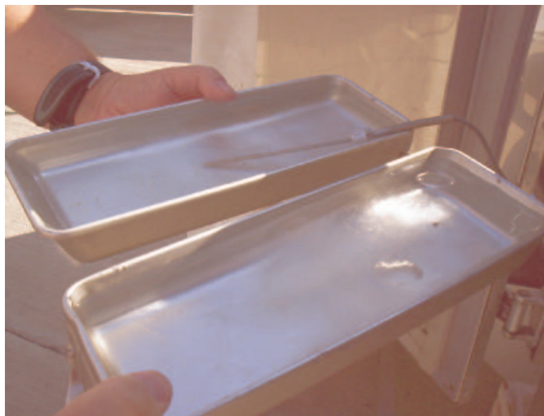
Fig. 6.43 Formación de hielo a una temperatura de -1^{\circ}\text{C}
