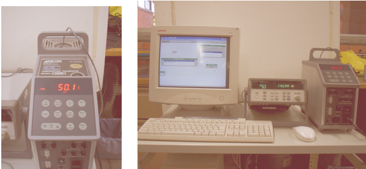
Fig. 4.14 Calibrador de temperatura y subsistema de calibración
