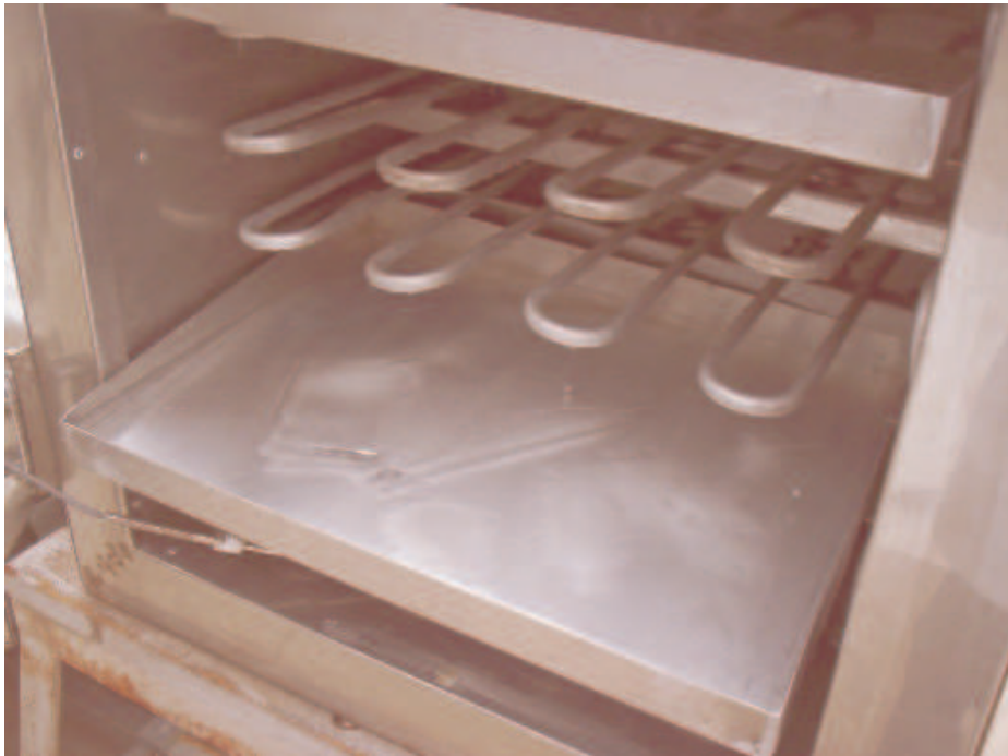
Fig. 6.38 Otra vista de la formación de hielo en la charola de la cámara de refrigeración
