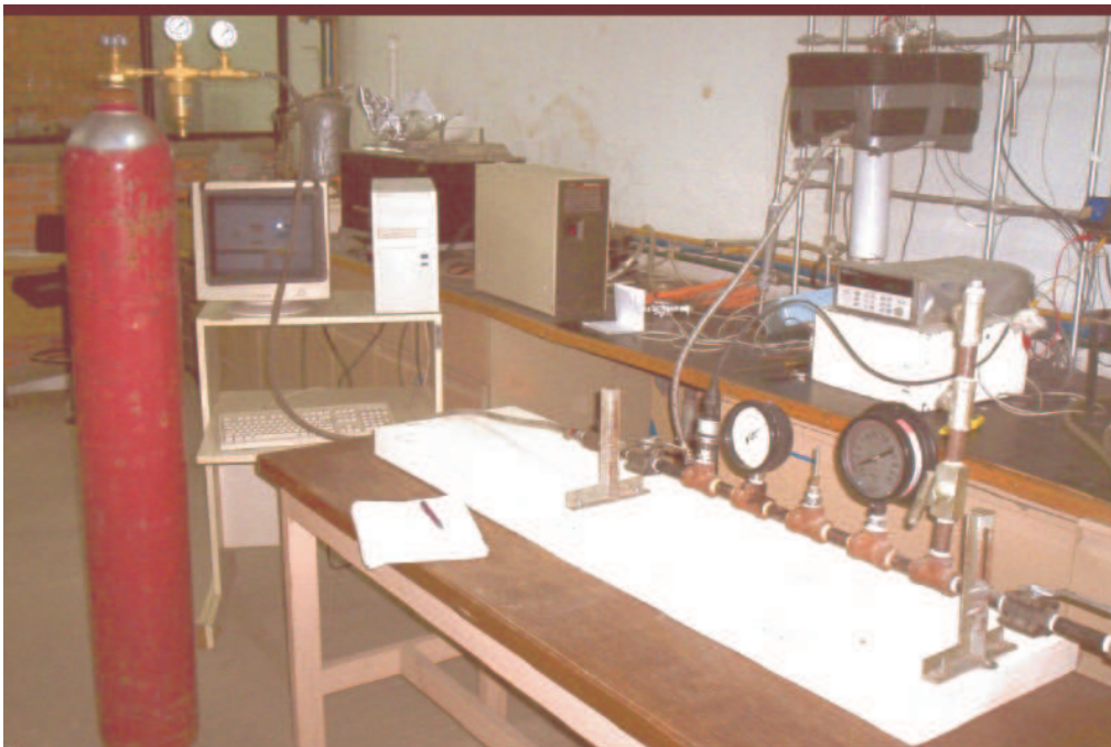
Fig. 4.16 Sistema de calibración de transductores de presión
