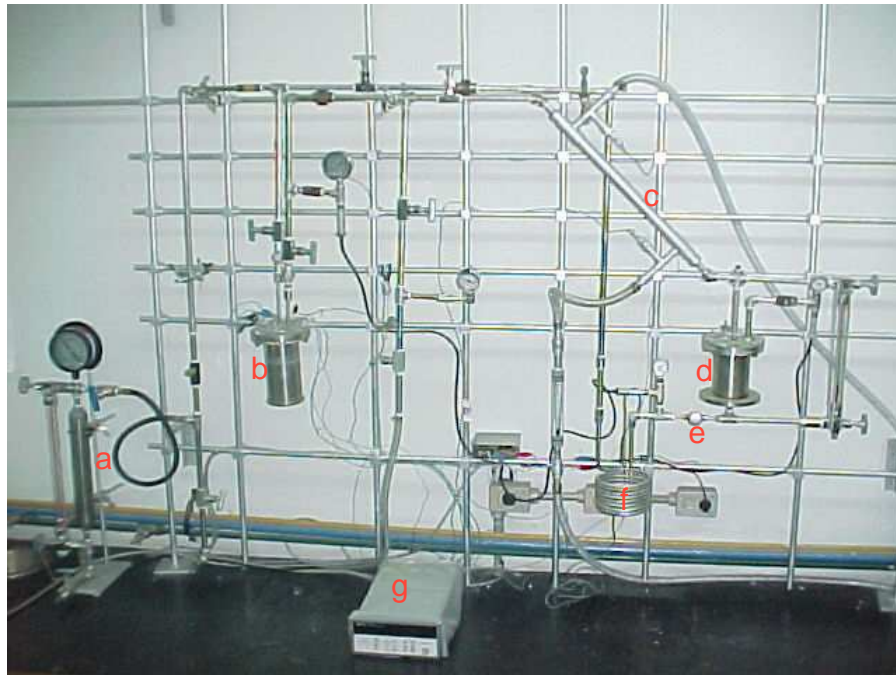
Fig. 4.6 Equipo experimental de refrigeración por absorción intermitente. a) sistema de suministro de amoníaco, b) reactor termoquímico, c) condensador, d) tanque de almacenamiento del refrigerante, e) válvula de expansión, f) evaporador y g) sistema de adquisición de datos
