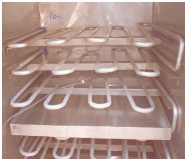
Fig. 6.15 Tubería por donde circula el amoníaco dentro del evaporador
