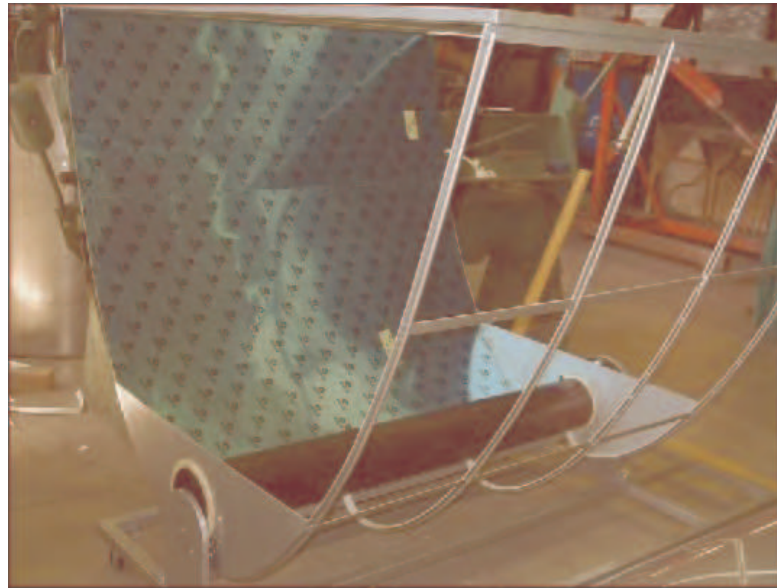
Fig. 6.8 Pintura especial que se le aplicó al generador. También se observan los arillos de Nylamid entre la placa y el generador
