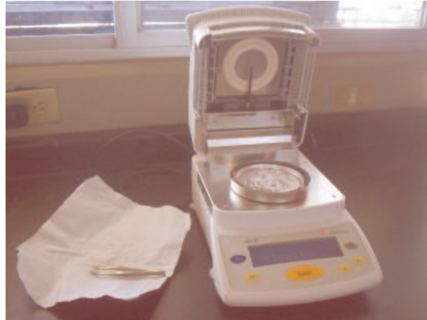
Fig. 6.26 Análisis de humedad del nitrato de litio
