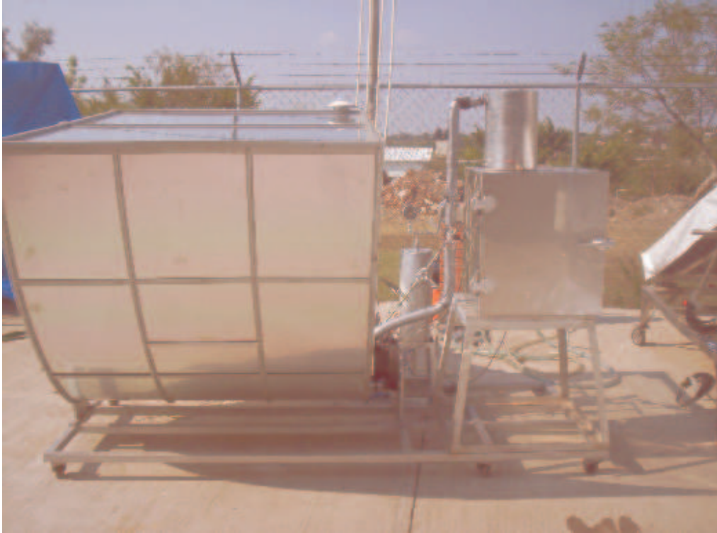
Fig. 6.19 Refrigerador solar intermitente totalmente ensamblado
