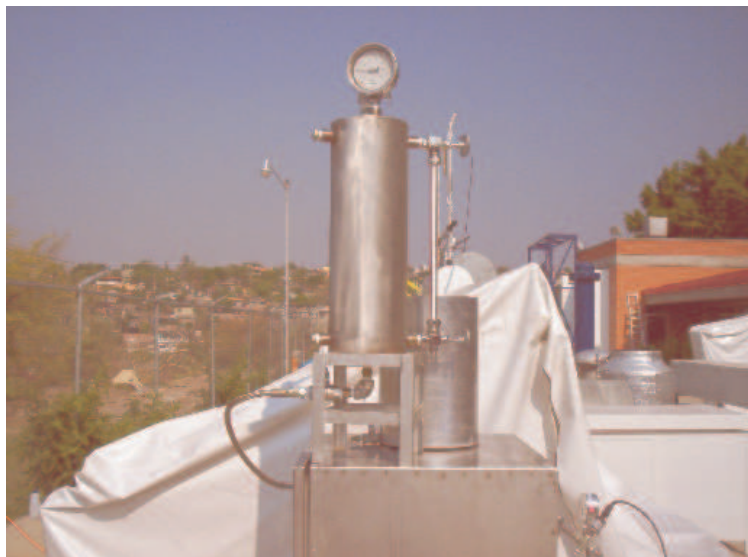
Fig. 6.27 Carga de la solución al sistema solar
