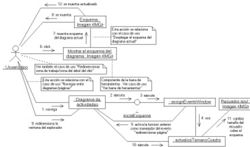
Fig. A.3 Modelo del diseño. Realizaciones de los casos de uso (19b/37). Realización del caso de uso "Redimensionar ventana explorador".
