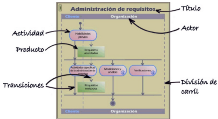
Fig. 7.27 Los diagramas de actividades tienen características que los hacen fácilmente identificables y legibles, independientemente del proceso que modelen (CE "Consistencia"): - Los nombres de las actividades, productos y actores comienzan con mayúscula. - El tamaño de letra en títulos, actores, actividades y productos es el mismo para cada uno. - Todos los diagramas, así como el resto de las páginas del sitio, poseen un título que se encuentra centrado en la parte superior. - El tamaño de las actividades y productos es generalmente el mismo. - El extremo de las transiciones (puntas de flecha) tiene el mismo tamaño. - La separación mínima entre transiciones, carriles, actividades y productos es la misma. Ver también la figura 7.38.
