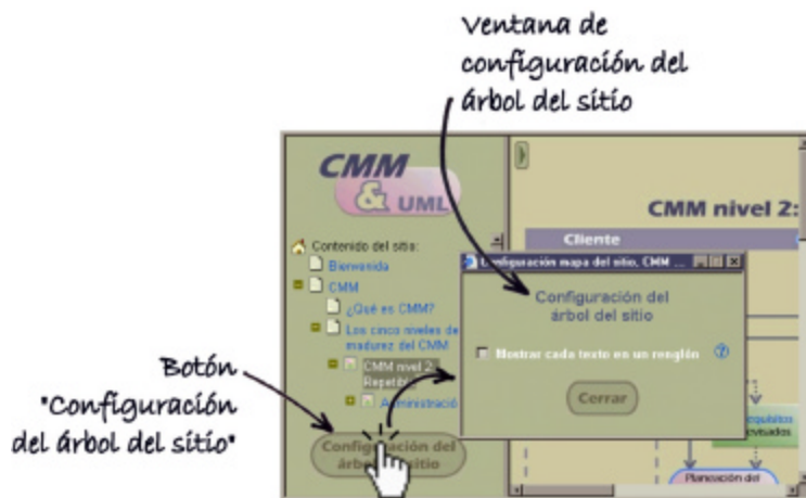
Fig. 7.16 Las opciones de configuración del árbol del sitio se encuentran en una ventana aparte, la cual sólo es visible si se oprime el botón "Configuración del árbol del sitio". De esta forma, se evita la presentación de elementos no relacionados con las actividades de navegación por el sitio WEB (CE "Densidad de la información").
