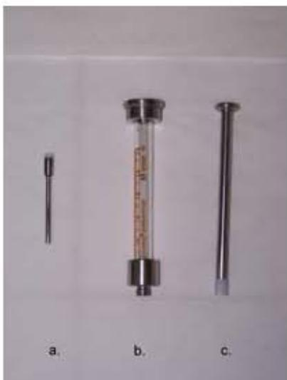
**Figura 3.2:** *Partes que conforman la jeringa: a. capilar, b. jeringa con terminaciones de metal, c. émbolo de metal con terminación de teflón.*
