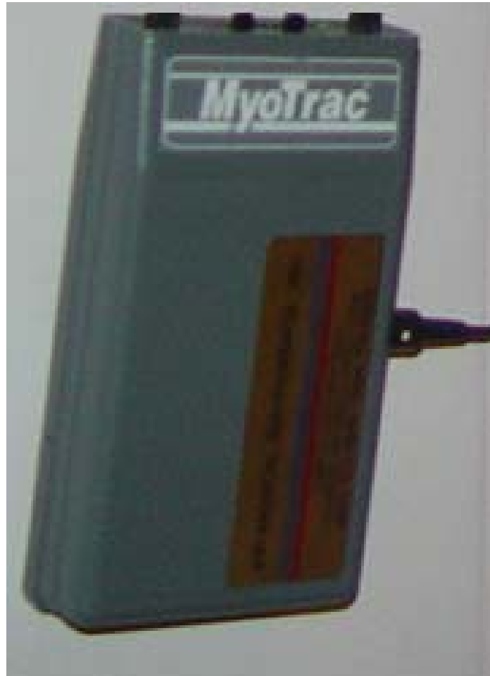
Figura 1. Electromiógrafo portátil con la capacidad para emitir luces y sonidos de retroalimentación al registrar potenciales entre 0-20, 0-200 y 0-2000 microvoltios.
