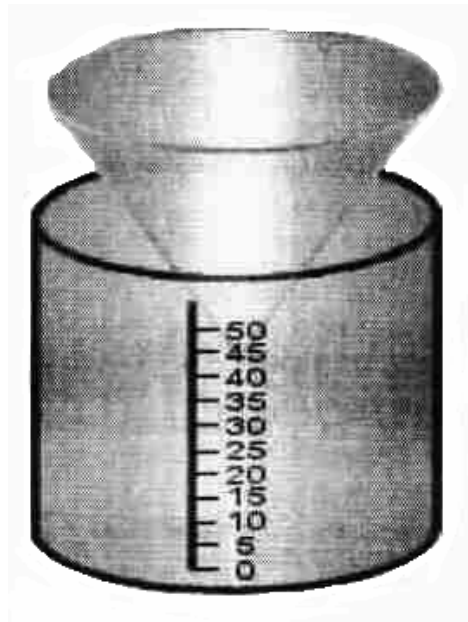
Figura 1.1h. Dibujo básico de un pluviómetro.
