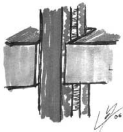
(Figura 4 Detalle de columna cortando losa)
